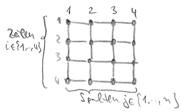
Wir identifizieren den Knoten  $(i,j)$  mit der Zahl  $(i-1)n+j$ . Dadurch werden die Knoten von  $G_{n \times n}$  wie folgt durchnummeriert:
