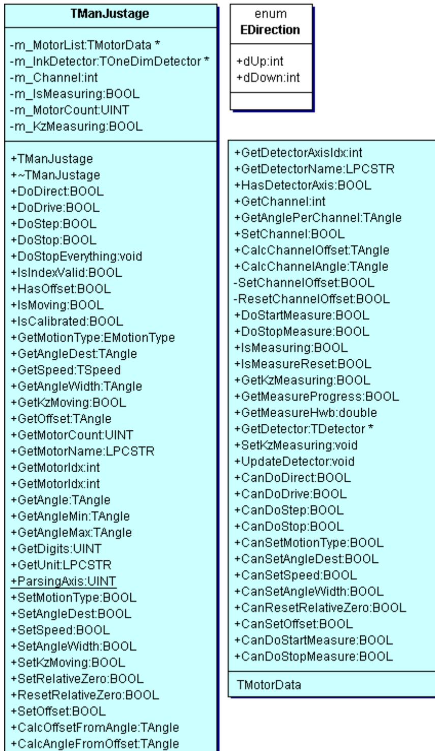
Abbildung 2 Klassendiagramm der Funktionalität zur neuen ‚Manuellen Justage‘
