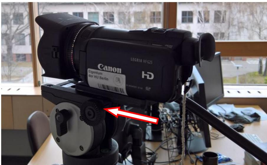
Schieben Sie die Kamera bitte in die Halterung bis sie vorn bündig ist:
