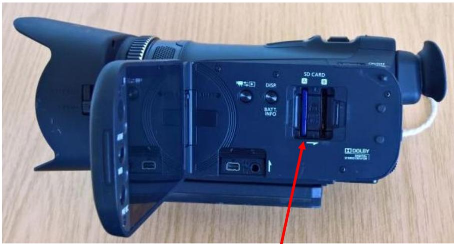
Nun können Sie mit leichtem Druck auf die **SD-Karte** diese lösen und dann herausziehen.
