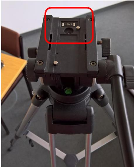
„Lens“ bedeutet: In diese Richtung muss die Kameraöffnung zeigen.
