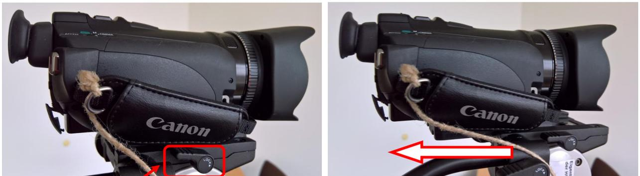
Dann bitte zuerst die Arretierung lösen und beim Schieben (im Bild nach links) werden Sie einen Widerstand bemerken. Die Kamera lässt sich erst ganz herausziehen, wenn Sie unterhalb der Kamera-Halterung einen Knopf drücken:
