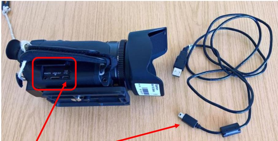
USB-Buchse, in die der kleinere der beiden Stecker gesteckt werden muss.
