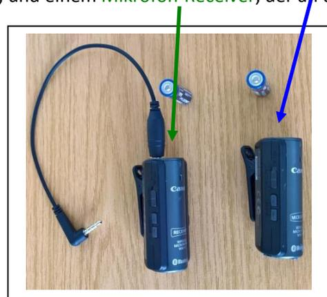
Um den Mikrofon-Receiver an der Kamera anzubringen, müssen Sie bitte dessen Klinkenstecker in die dafür vorgesehene Öffnung an der Kamera vorn rechts stecken:
