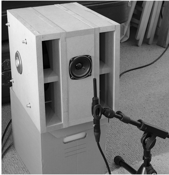
Abbildung 36: Einmessen eines selbst gebauten Lautsprechers mit einem Messmikrofon. Das Mikrofon befindet sich etwa 10 cm vor der Kalotte der Lautsprechermembran.
