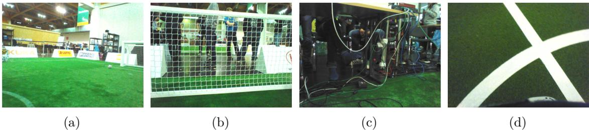
Abbildung 2.3.1: Dargestellt sind Kamerabilder des Roboters vom Spielfeld. Felder im Bild liegen an der unteren Bildgrenze an (a). Fehler in der Feldfarbendetektion sind wahrscheinlich, unter anderem durch Reflexionen in Tischbeinen oder grünen Objekten außerhalb des Feldes (c). Grüne Regionen können durch weiße Linien unterbrochen werden (d) oder auch als benachbartes Spielfeld außerhalb der eigenen Feldgrenzen auftreten (b).
