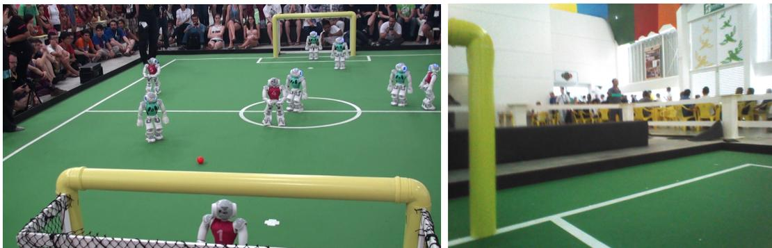
**Abbildung 5.1:** Das linke Bild zeigt die Situation während eines Spiels. Das Publikum sitzt sehr dicht am Spielfeldrand. Kurzzeitige Pfostensichtungen in Armen und Beinen sind möglich. Das rechte Bild zeigt aus der Roboterperspektive einen Torpfosten und gelbe Stühle im Hintergrund. Unter Umständen liefert die Bildverarbeitung ein dauerhaftes Torpfostenperzept in der Nähe der Stühle.
