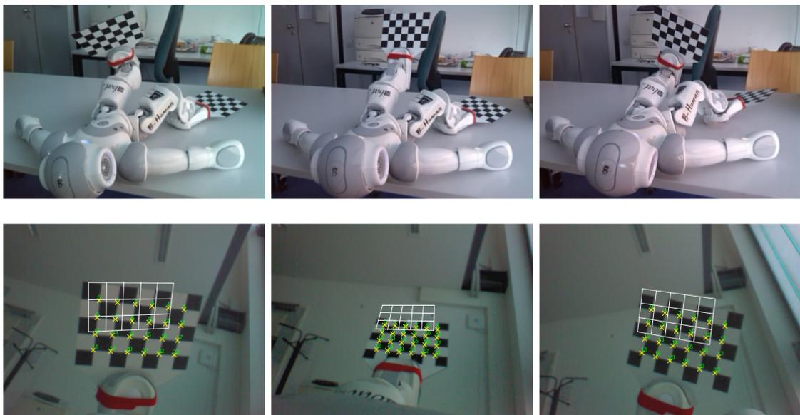
**Abbildung 6.6:** *Diese Abbildungen zeigen die autonome Messungsphase des Roboters zum Kalibrieren der Kamera in Abhängigkeit der kinematischen Konfiguration [KRL14]. Die oberen Bilder zeigen verschiedene Konfigurationen der Gelenke. Ebenfalls gut zu erkennen ist das fest justierte Schachbrettmuster am Fuß des Roboters. Die unteren Bilder zeigen die gesehenen und projizierten Punkte, die als Grundlage zur Kalibrierung dienen.*
