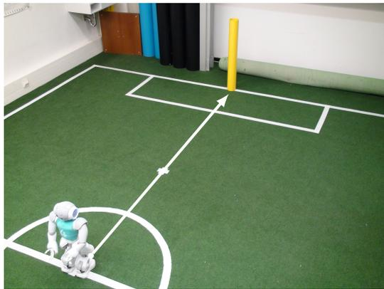
**Abbildung 6.1:** Der Roboter steht während des Experiments an einem festen Punkt mit einem festen Abstand von 3 m zum Pfosten. Der weiße Pfeil symbolisiert die untersuchte Entfernungsmessung. Gemessen wird der Abstand zum Ball, ausgehend von der Projektion des Körperschwerpunktes auf dem Boden.
