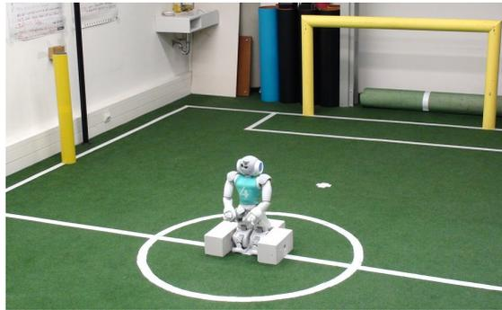
**Abbildung 8.8:** *Experimentaufbau mit einem zusätzlichen Torpfosten. Links im Bild sieht man einen dritten gelben Torpfosten, der aus der Sicht der Bildverarbeitung identisch mit einem regulären Torpfosten ist.*
