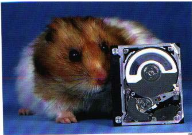
So groß wie ein Zweimarkstück: Auf die 16 Gramm leichte Mini-Festplatte von IBM passt 1 Gigabyte an Daten.
