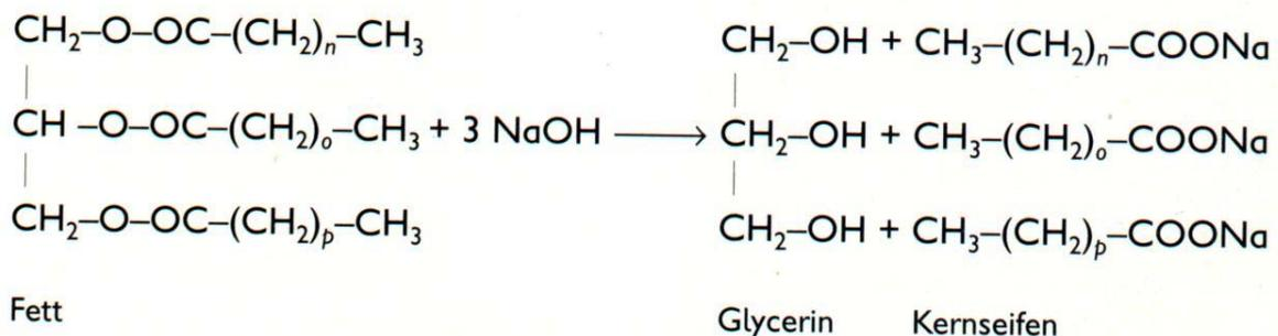
Chemisch gesehen läuft beim Seifensieden eine hydrolytische Esterspaltung ab. Aus diesem Grund werden alle Reaktionen dieses Typs auch Verseifung genannt.
