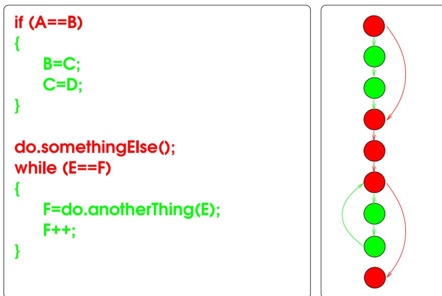
Abbildung 5.4: Mögliche Anzeige auf Basis von Instrumentierung zur Auswertung der Zweigüberdeckung
