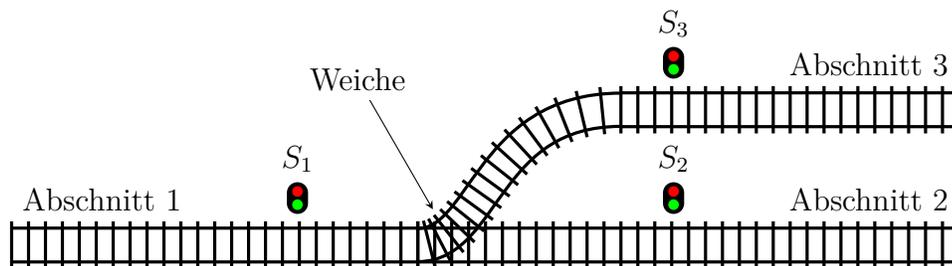
Die drei Signale  $S_1$ ,  $S_2$  und  $S_3$  geben an, ob ein Zug vom entsprechenden Gleisabschnitt über die Weiche fahren darf: Leuchtet  $S_i$  grün, dann darf ein Zug vom Gleisabschnitt  $i$  aus über die Weiche fahren.
