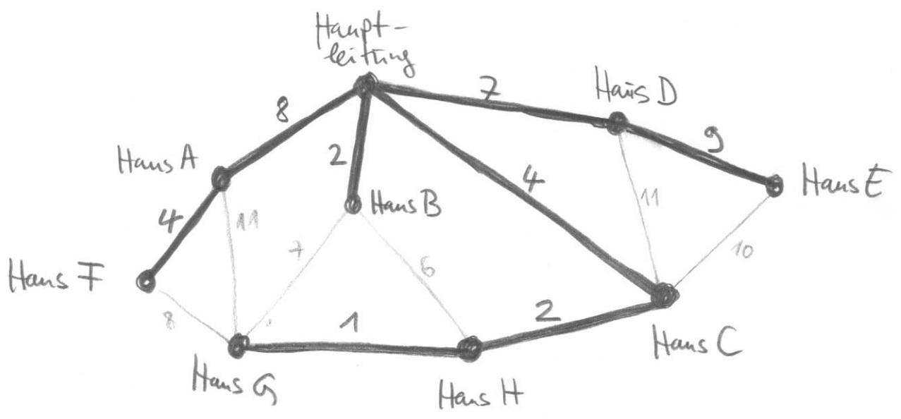
Verlegt die Firma genau diese Leitungen, so hat sie das neue Wohngebiet mit den geringstmöglichen Kosten ans Kabelfernsehen angeschlossen.
