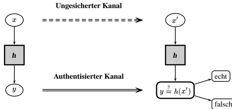
**Abbildung 1** Einsatz eines MDC  $h$  zur Überprüfung der Integrität eines Datensatzes  $x$ .
