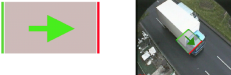
Abb.2: Modell der EOS und seine Projektion in das Kamerabild
