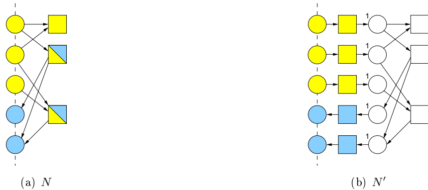
Abbildung 2.7: Transformation eines oWFN N in ein oWFN N' mit internem Nachrichtenpuffer
